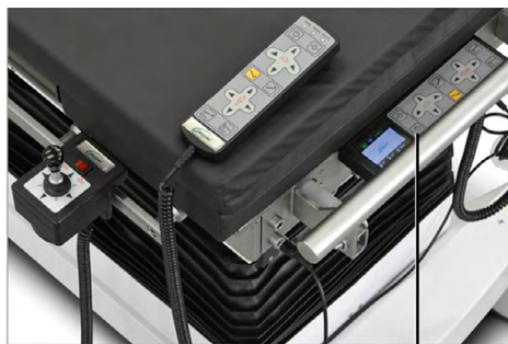
Рисунок 6 – Кнопка включения на основном пульте управления на колонне стола «Медин-Сафис», 1 – расположение кнопки
