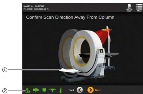
Рисунок 16 – Экран подтверждения направления перемещения гентри: 1 – направление перемещения от колонны, 2 – значок SAB
