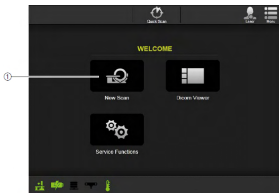
Рисунок 10 – Экран WELCOME консоли управления в режиме сканирования: 1 – кнопка запуска нового сканирования
