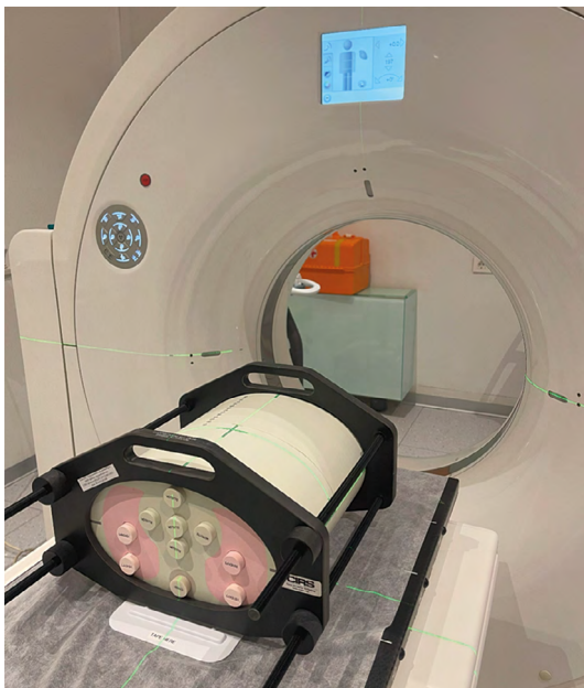
Рисунок 2 – Общий вид фантома при сканировании на КТ
