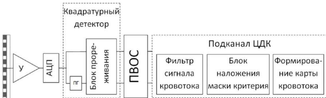
Рисунок 13 – Схема подканала ЦДК и предварительной обработки
