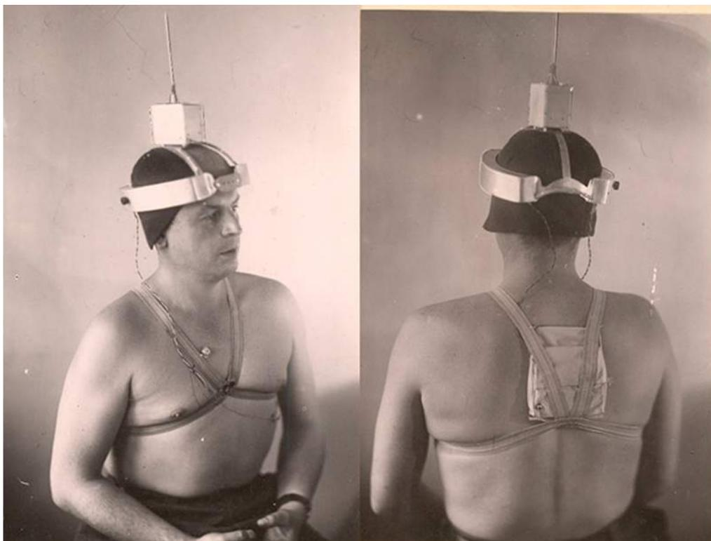
Рисунок 4.2 – Телеэлектрокардиограф «ТЭК-1», передающая часть на испытуемом (РГАС Ф. Р-179, Оп. 2–1, Д. 587, Л. 19)
