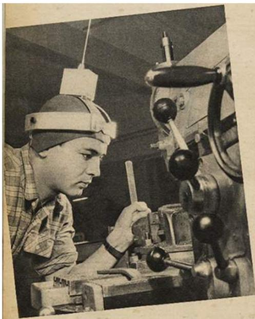
**Н** А ГОЛОВЕ рабочего-фрезеровщика легкий металлический шлем с радио-передатчиком и антенной, делающий его похожим на фантастического марсианина. Это — телеэлектрокардиограф, оригинальный прибор, в котором использованы новейшие достижения радиоэлектроники.
