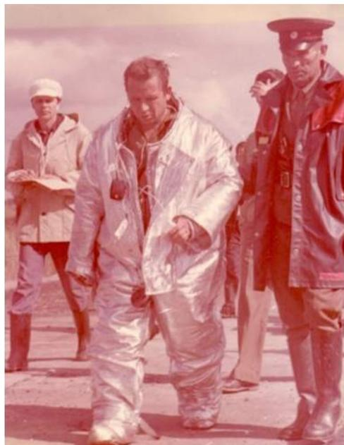
*Рисунок 5.12 – Испытание теплозащитных костюмов на полигоне в Перми, 1984 г. Осуществлялась биотелеметрия частоты пульса, температуры тела и иных параметров. Слева на заднем фоне – Ю. Г. Солонин. Фотография из личного архива Ю. Г. Солонина*
