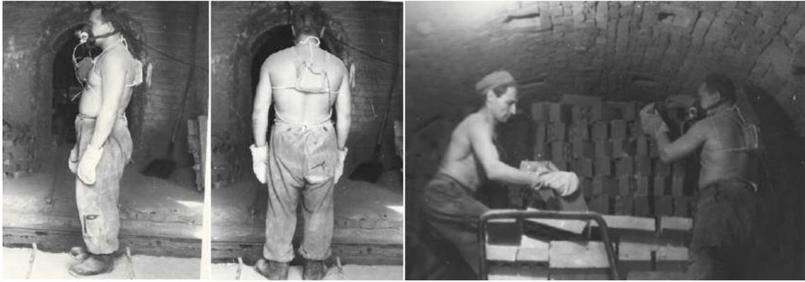
*Рисунок 5.5 – Размещение биотелеметрической аппаратуры на объекте исследования – рабочем кирпичного завода (на лице маска с вмонтированным датчиком частоты дыхания и минутного объема дыхания, на груди прибор «КРП-2» с питанием (виден электрод для отведения биотоков сердца), на спине прибор «КРП-5» (питание в кармане брюк). Выполнение трудовых операций (обследуемый рабочий справа). Фотографии из личного архива Ю. Г. Солонина*
