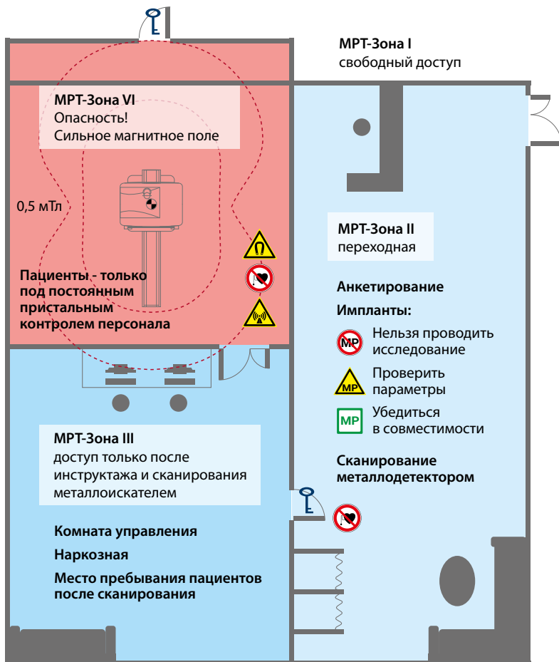
Рисунок 3 – Схема зонирования пространства кабинета МРТ
